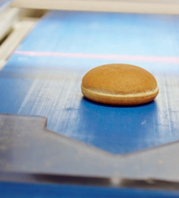
Strenge Qualitätskontrolle: Jedes Brötchen wird vor dem Verpacken per Videokamera vermessen.
