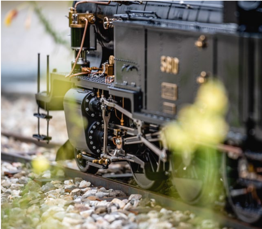
Dampfzylinder, Schieberkasten, Kreuzkopf, Kuppelstangen, alles stimmt an der Lokomotive bis ins letzte Detail.
